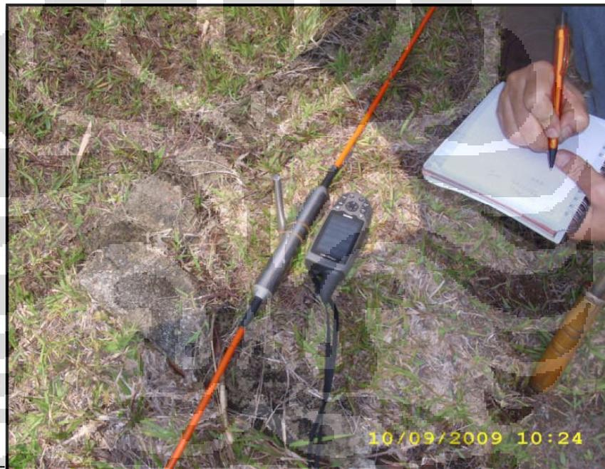
Gambar 4.5 Pengukuran posisi setiap elektroda dengan menggunakan GPS
